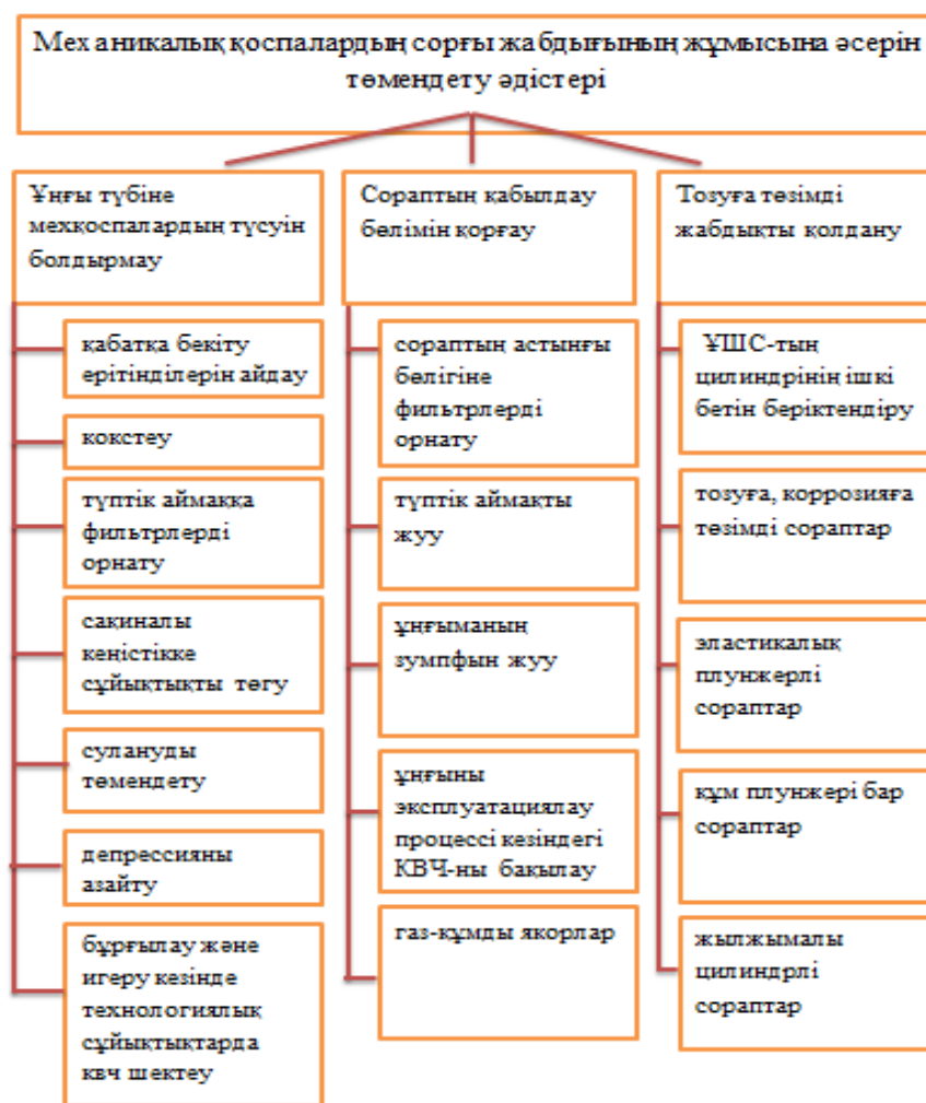
1.15 Сурет – Ұнғыма ішіндегі жабдықтарды механикалық қоспалардан қорғау әдістерінің құрылымдық сұлбасы
